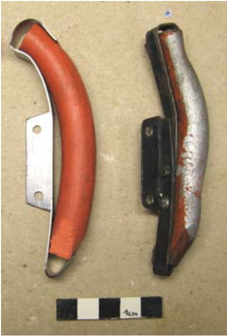
Abbildung 4: Auffangpuffer aus Gummi, rechts das Originalteil und links die Replik für den einmaligen Durchlauf
